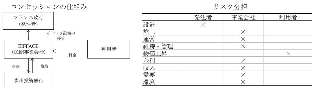
図表 11 フランス ミヨー高架橋のコンセッションの仕組みとリスク分担
